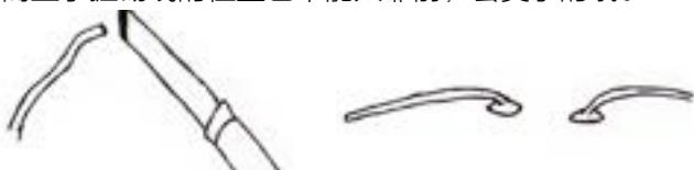
现在开始焊接第一个焊盘。先把焊枪的笔尖凑到焊盘上，然后将锡线凑到焊盘上。正常的情况下，融化的锡线会自动附着在焊盘上，形成一个漂亮的火山状。
